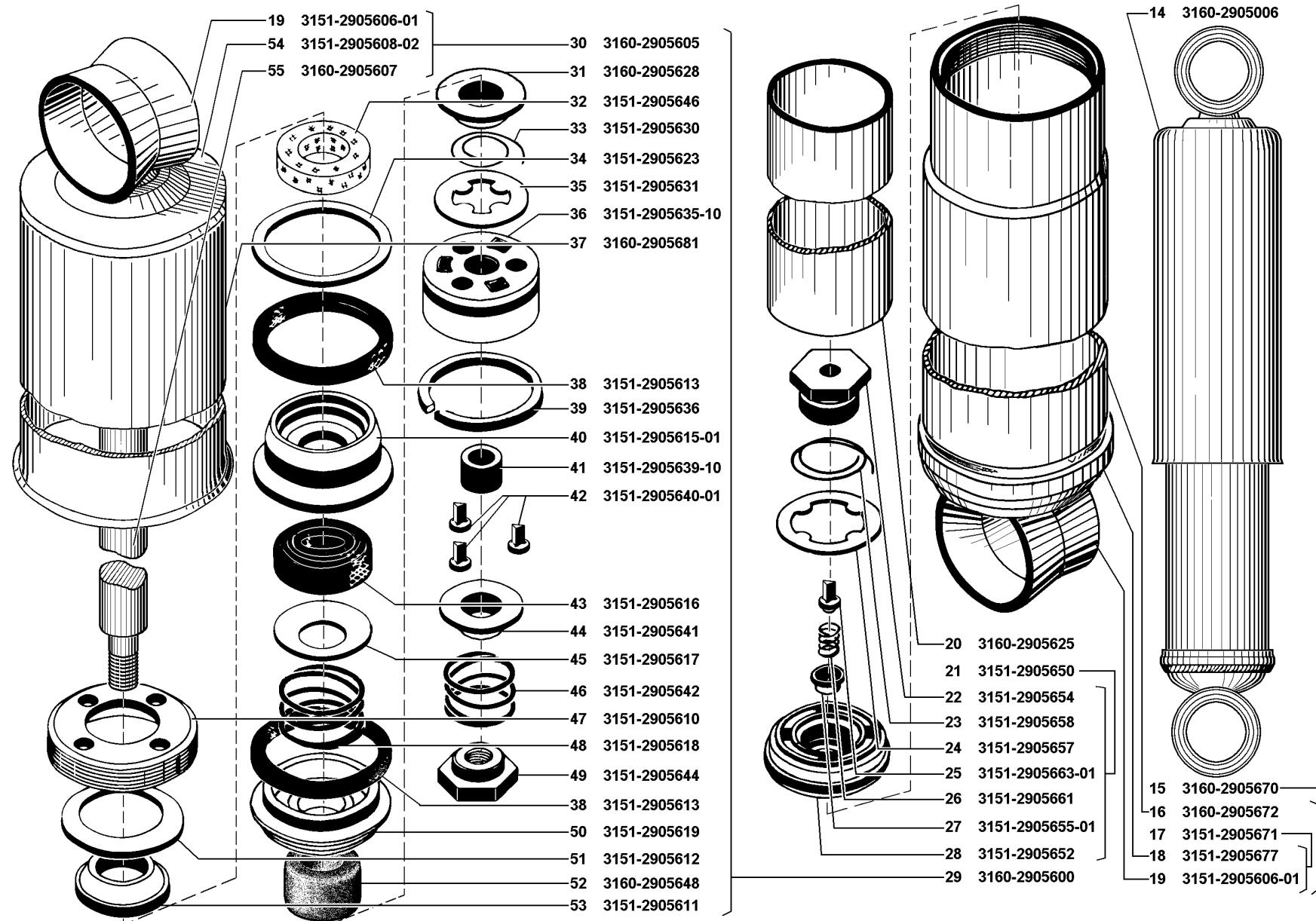
Рис. 65. Амортизаторы передние (2905)/2
